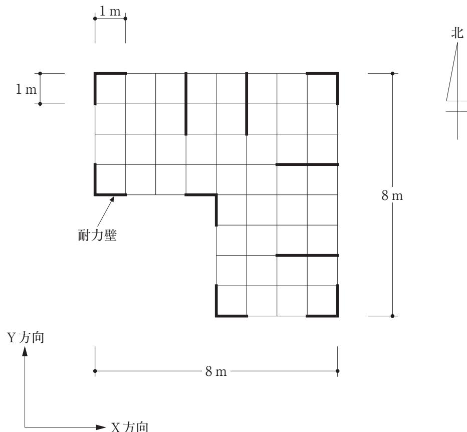
1. 「X方向の北側の側端部分」及び「Y方向の東側の側端部分」の必要壁量は、いずれも  $2.4 \text{ m}$  である。
