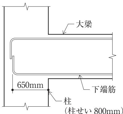
3. 大梁の下端筋(D32)の柱内折曲げ定着
