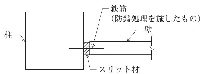
4. 柱と壁の間に設けた完全スリットにおいて、面外変形を抑えるための鉄筋を設けた。
