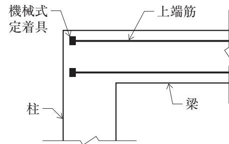
2. 最上階の外柱梁接合部(L形接合部)の配筋において、梁上端筋を機械式定着具で定着した。
