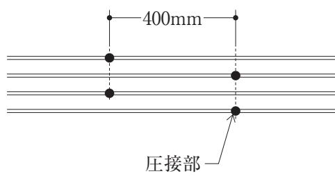
4. 鉄筋(D25)のガス圧接継手の位置
