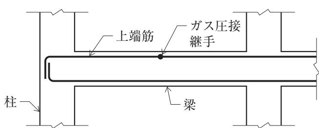
1. 梁上端筋の配筋において、ガス圧接継手をスパンの中央部に設けた。
